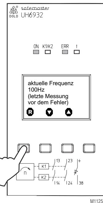
Wird ein Systemfehler nach dem Reset erneut erkannt, muss das Gerät an den Hersteller zurückgesendet werden.
