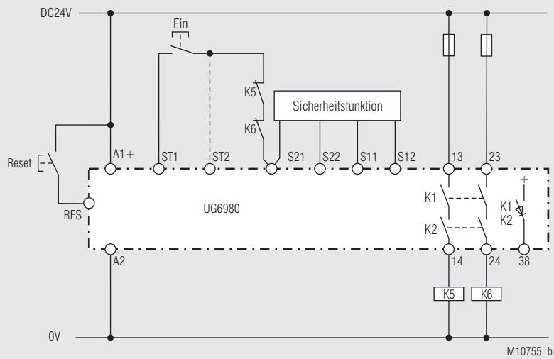
Sicherheitsfunktion: siehe unten, Hand-Start (für automatischer Start, anstatt Ein-Taster eine Verbindung zu ST2 herstellen).
