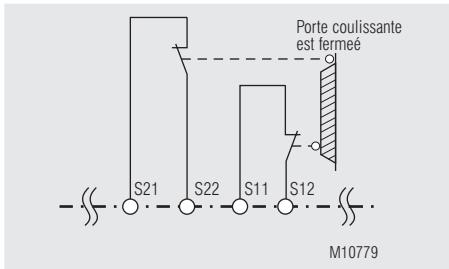
Fct.: Porte de protection (2), avec détection des courts-circuits transversaux
