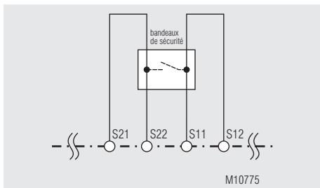
Fct.: Tapis / bandeaux de sécurité (4), avec détection des courts-circuits transversaux
