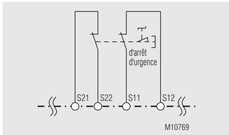
Fct.: Arrêt d'urgence (1), avec détection des courts-circuits transversaux
