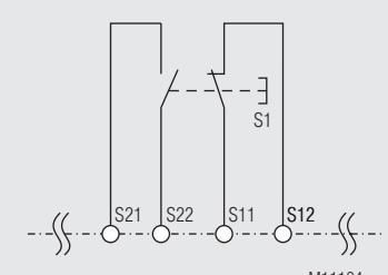
Fct.: Interrupteur complémentaire (5), avec détection des courts-circuits transversaux
