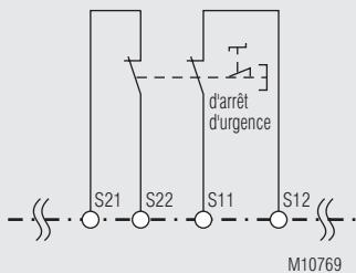
Fct.: Arrêt d'urgence (1), avec détection des courts-circuits transversaux
