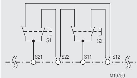
Fct.: Commande bimanuelle (3), avec détection des courts-circuits transversaux
