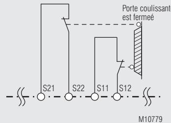
Fct.: Porte de protection (2), avec détection des courts-circuits transversaux
