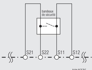
Fct.: Tapis / bandeaux de sécurité (4), avec détection des courts-circuits transversaux
