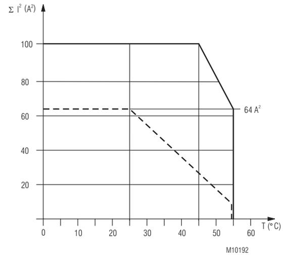
— AC/DC 24V Appareils non accolés, avec circulation d'air
