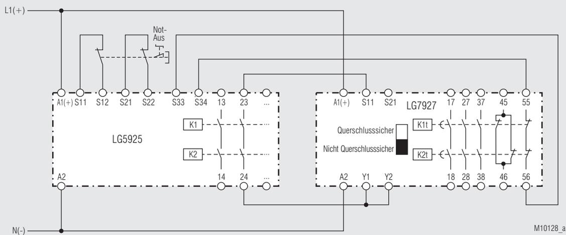
LG 5925 mit LG 7928, nicht Querschluss­sicher, geeignet bis SIL2, Performance Level d, Kat. 3
