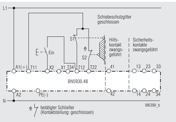
Zweikanalige Überwachung eines Schiebeschutzgitters.
