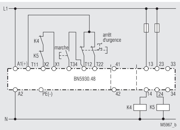
Amplification des contacts à deux canaux avec contacteurs externes.
