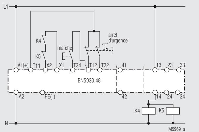
Amplification des contacts par contacteurs externes avec niveau de sécurité réduit.
