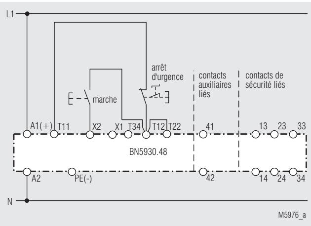
Couplage d'arrêt d'urgence à un canal. Ce couplage n'offre pas de redondance dans le circuit des émetteurs d'ordres d'arrêt d'urgence.
