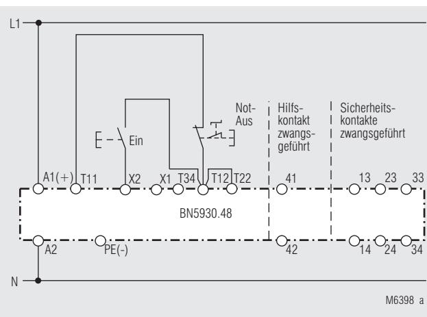
Einkanalige Not-Aus-Schaltung. Diese Schaltung hat keine Redundanz im Not-Aus-Befehlskreis.
