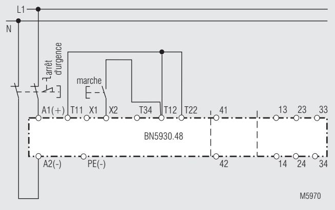
Couplage d'arrêt d'urgence bipolaire avec émetteur d'ordres d'arrêt d'urgence dans le circuit d'alimentation.
